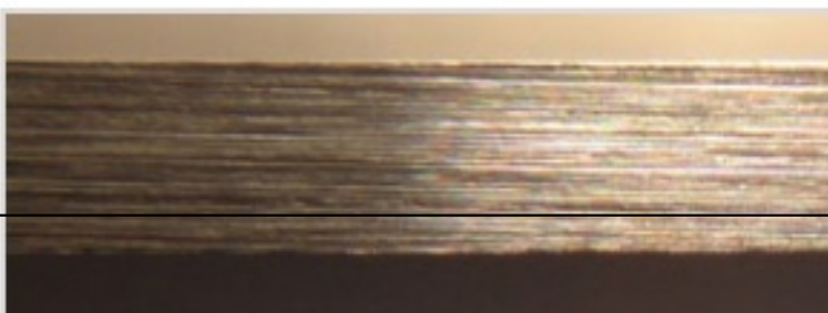
Slijpresultaat traditioneel blok met groene diamant plaatjes op een aluminium balk
