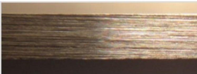
Slijpresultaat traditioneel blok met rode diamant plaatjes op een aluminium balk
